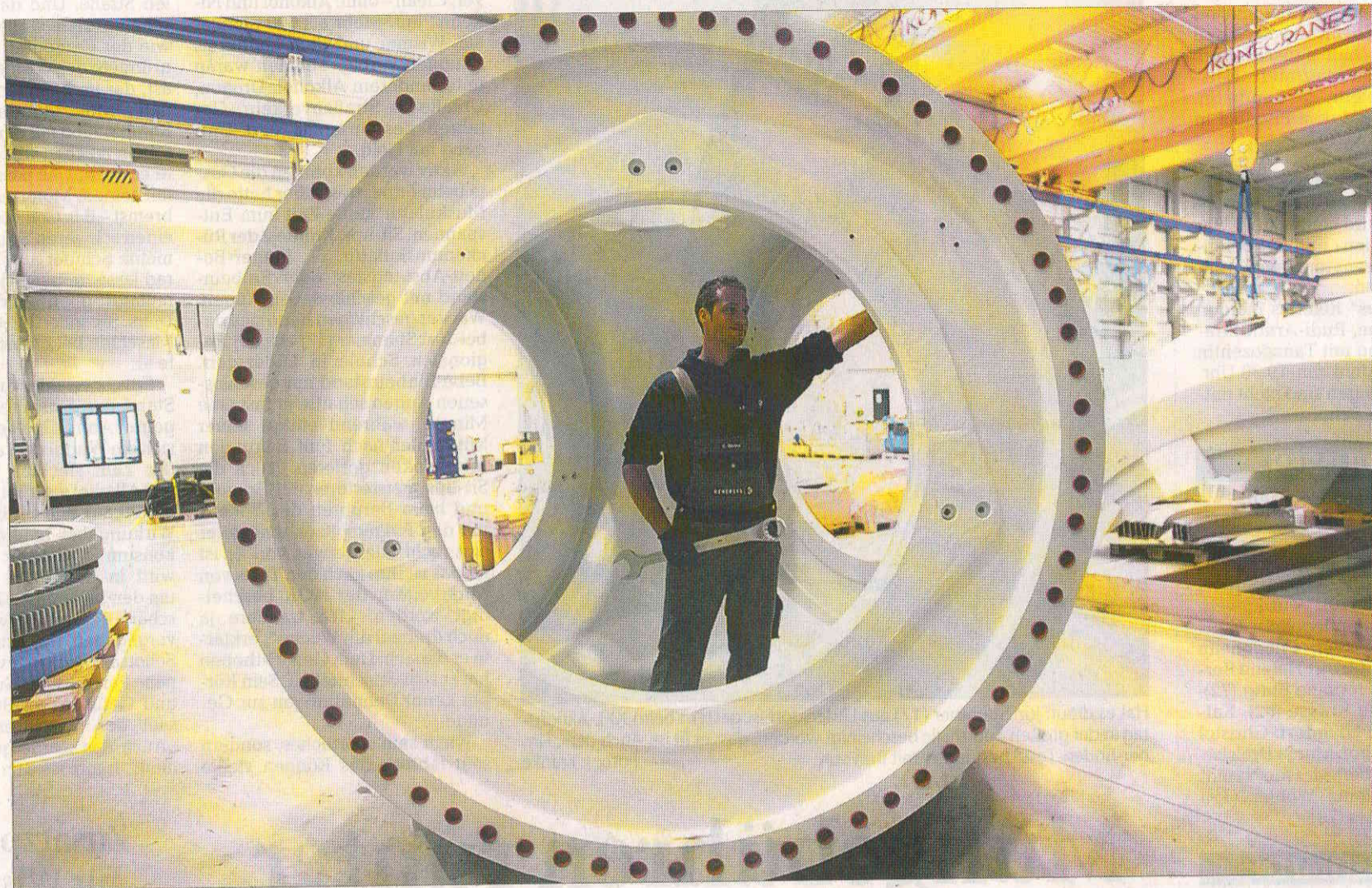
Große Dimensionen sind für den Wismarer Teamleiter und Monteur Christian Straka (26) kein Thema. Das schwergewichtige Teil aus einem Guss bildet die stabile Basis der Nabe für die künftige Windkraftanlage. Sie erhält noch eine Verkleidung und trägt später die Flügel. Fotos (3): H.-J. Zeigert
